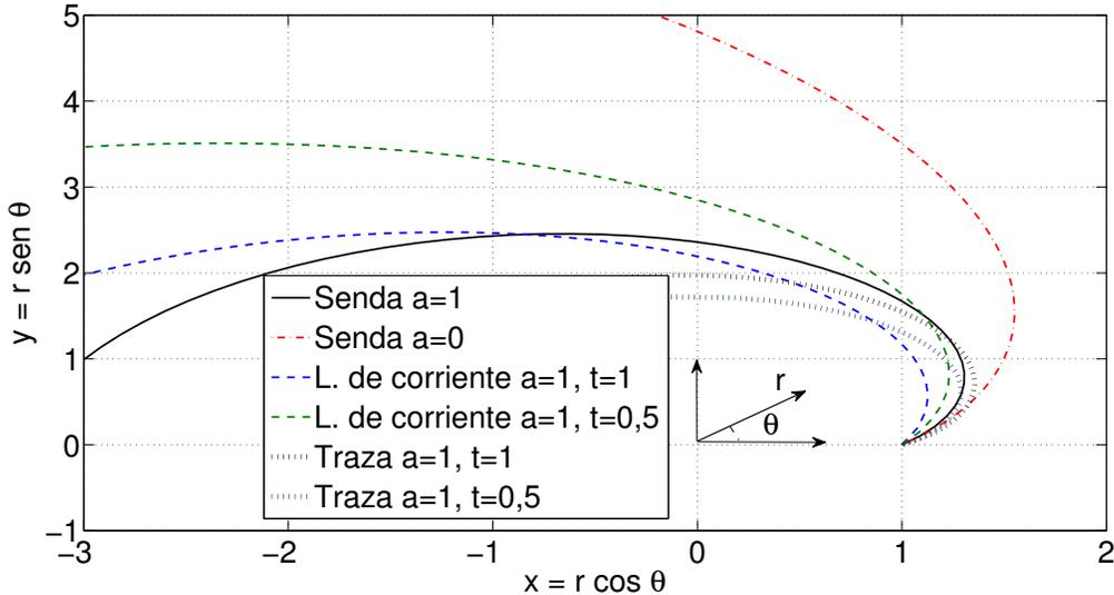
Figura 3.5: Sendas, líneas de corriente y trazas que pasan por el punto  $(r = r_0 = 1, \theta = 0)$  para  $A = B = 1$  y distintos valores de  $a$  y  $t$ .
