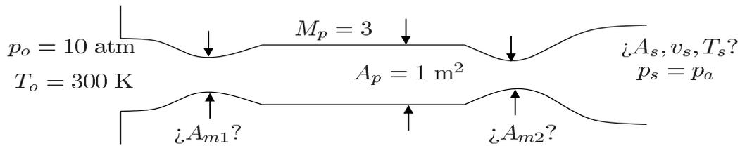
Figura 18.24: Túnel aerodinámico
