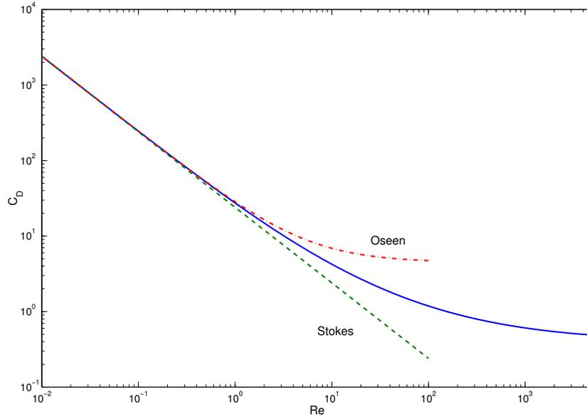
Figura 14.3: Coeficiente de resistencia  $C_D$  para una esfera. La curva continua es una interpolación de numerosos datos experimentales dada por  $C_D = 24/Re + 6/(1 + \sqrt{Re}) + 0,4$  (White, 2004), válida hasta  $Re \approx 2,5 \times 10^5$  (ver también problema propuesto 1 de la lección 10). La curva a trazos es la Ley de Stokes (14.47) y la curva de trazos y puntos es la Ley de Oseen (14.62).
