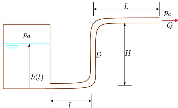
Figura 21.18: Descarga por un tubo en S.
