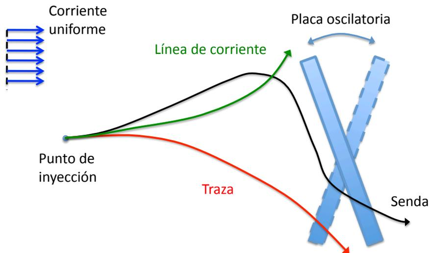
Figura 3.3: Esquema de las diferencias entre traza, línea de corriente y senda en un instante  $t$  de un movimiento no estacionario originado por la oscilación de una placa en una corriente uniforme. Pulsar aquí para ver animación del vídeo de S. J. Kline 'Flow visualization'.
