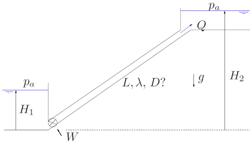
Figura 21.30: Sistema de almacenamiento de energía bomba-turbina
