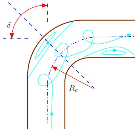
Figura 21.9: Esquema de la corriente en un codo.
